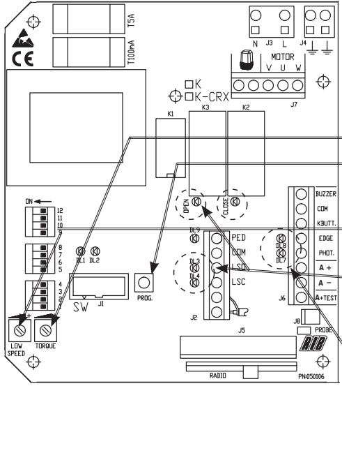
(الف) ریزکلید های 1-2-3-4-5-6-7-8-12 DIP را در حالت خاموش (OFF) و ریزکلید های 9-10-11-10 DIP را در حالت روشن (ON) قرار دهید.
