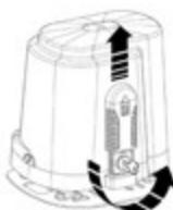
Verze motoru (otočte klíč proti směru hodinových ručiček, dokud není dosaženo limitu bez vynucení) a posuňte bránu rukou.
