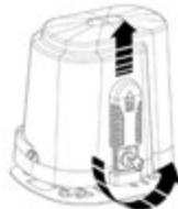
Den Motor entblocken (den Schlüssel im Gegenuhrzeigersinn bis zum Anschlag drehen, ohne ihn dabei zu forcieren) und das Tor bei Hand verfahren.
