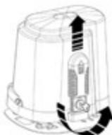
Sbloccare il motore (girare la chiave in senso antiorario fino a fine corsa senza forzare) e muovere il cancello manualmente.
