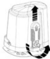
Należy zwolnić silnik (należy przekrącić klucz w stronę przeciwną do ruchu wskazówek zegara aż do momentu osiągnięcia oporu bez wysiłku), a następnie przesunąć bramę ręcznie.
