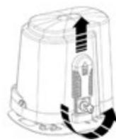
Разблокировать двигатель (поворнуть ключ против часовой стрелки до концевика без приложения усилия) и передвинуть ворота вручную.
