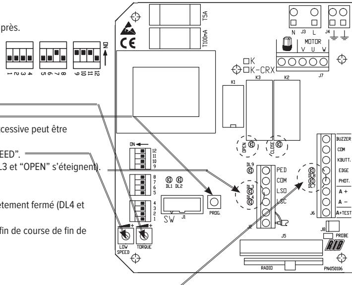
c) Positionner le potentiomètre de réglage de la force "TORQUE" sur minimum
