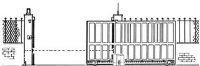
Motor je nastaven na otevřený směrem doprava.
